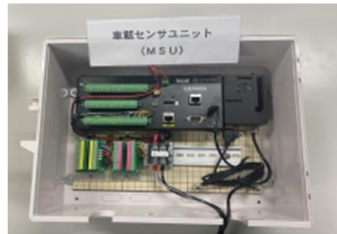
図4 路面センシング信号処理システム
