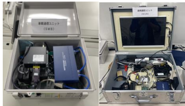
図7 車車間通信サーバシステム(左)車路通信用サーバシステム(右)
